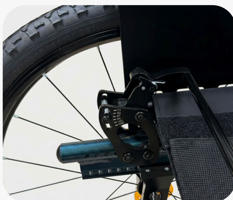
Reclinación de espaldar graduable por tornillo 73°, 80°, 87°, 94°, 101°, 108°.
