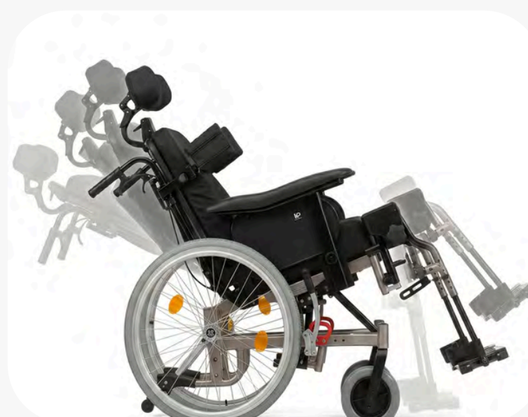
Reclinación de espaldas 90° - 120° por guaya y basculación 0° - 20° por guaya.
