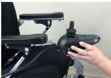
FIG. 8 — Instalación del controlador
