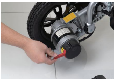
FIG. 20 — Manija de cambio de modo
