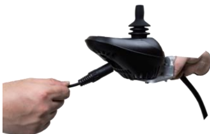
FIG. — Carga a través del controlador
